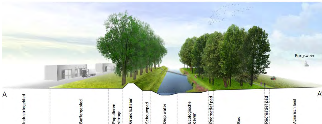
Figuur 16. Schematische weergave van de Wal van Borgsweer, kan ingepast worden in het nieuw aan te leggen spuikanaal
