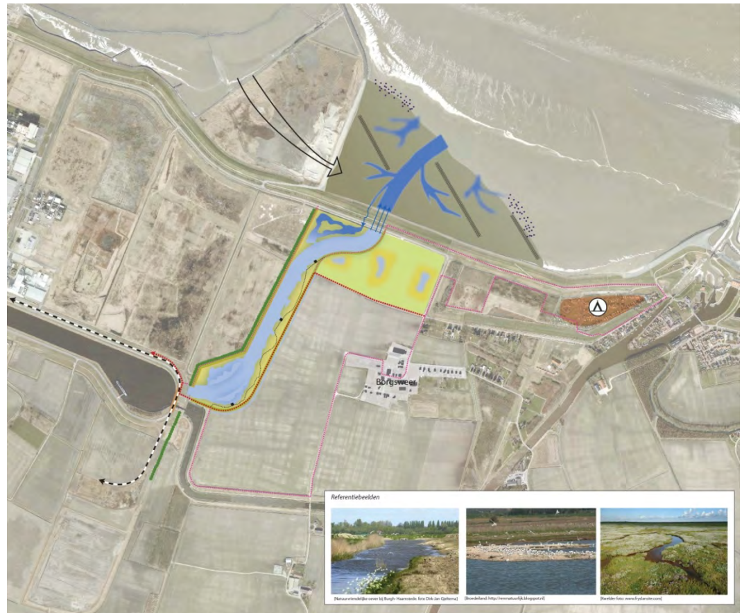
Figuur 15. Ruimtelijk ontwerp nieuwe spuilocatie en zoet-zout overgang nabij de pier van Oterdum
